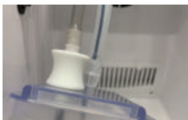
5. Vložte NTC a integrovanou hadičku na mléko do víka nádoby na mléko
